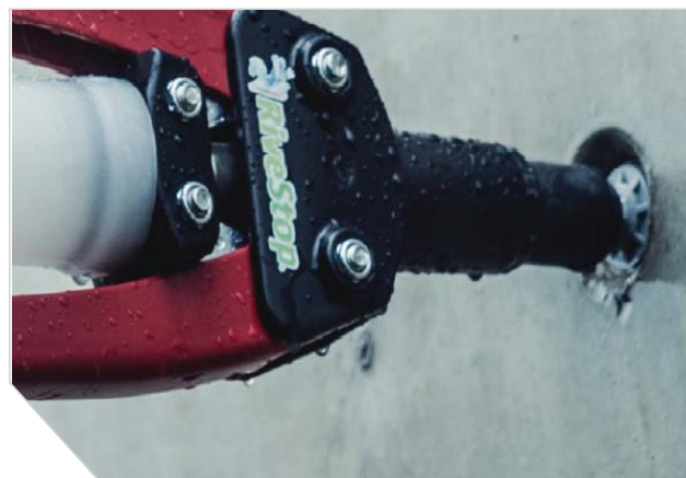
Rivestop poptang (HauCon varenummer 18858) ved montering av Rivestop.
